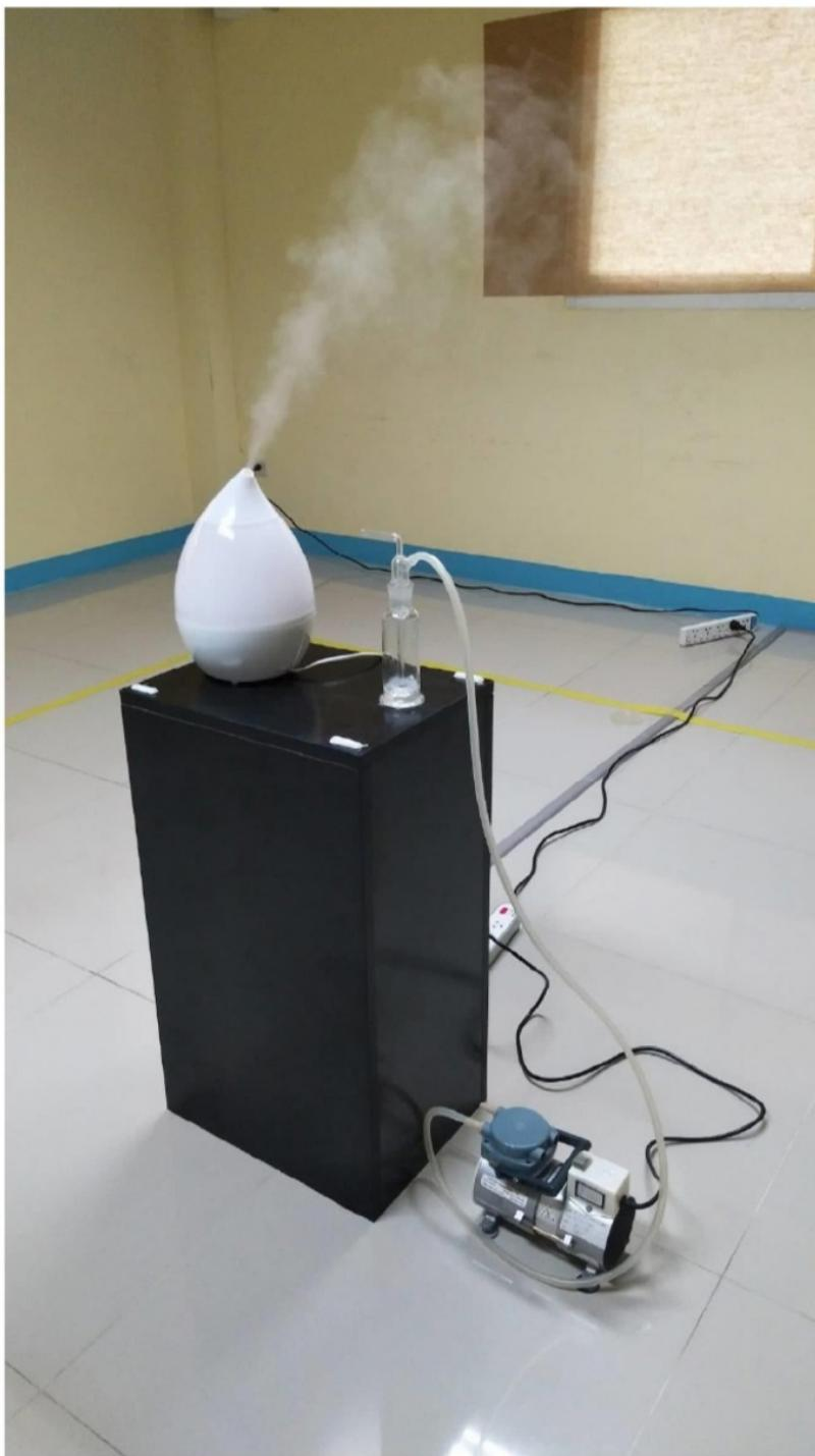
รูปที่ 4 เชื้อแบคทีเรียที่ถูกพ่นออกมายากเครื่องพ่นละอองฝอย พร้อมกับการเปิดหลอด UVC ผ่าเชื้อไวรัส และเปิดบีบดูดอากาศเพื่อเก็บตัวอย่างเชื้อแบคทีเรียที่ลอยอยู่ในอากาศเข้าไปเก็บไว้ในหลอดเก็บตัวอย่างอากาศผ่านน้ำ (Impinger) และ จานแพะเชือ 8 จุด และนำน้ำห้าในขวด Impinger ไป spread ลงบน Agar plate และนำจานแพะเชื้อแบคทีเรียทั้ง 8 จุดไปปั่นที่ 35 องศาเซลเซียส เป็นเวลา 18 – 24 ชั่วโมงเพื่อเพาะเชื้อแบคทีเรีย
