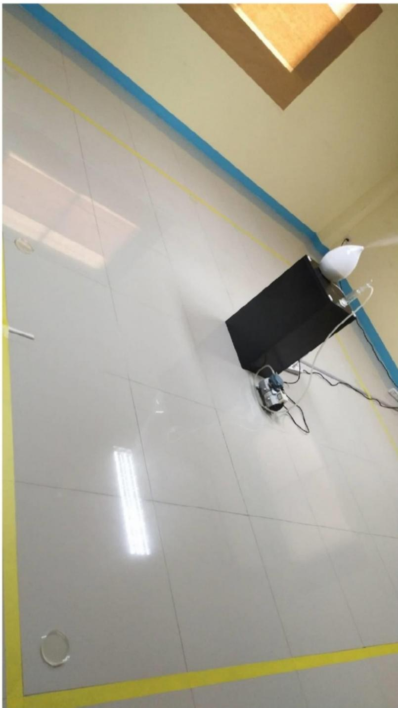
รูปที่ 5 เชื้อแบคทีเรียที่ถูกพ่นออกมายจากเครื่องพ่นละอองฝอย พร้อมกับการเปิดหลอด UVC ผ่าเชื้อโรค และ เปิดบ้มดูดอากาศเพื่อเก็บตัวอย่างเชื้อแบคทีเรียที่ลอยอยู่ในอากาศเข้าไปเก็บไว้ในหลอดเก็บตัวอย่างอากาศผ่านน้ำ (Impinger) และจานเพาะเชื้อทั้ง 8 จุด แล้วนำน้ำในขวด Impinger ที่ spread ลงบน Agar plate และจานเพาะเชื้อแบคทีเรียทั้ง 8 จุดไปบ่มที่ 35 องศาเซลเซียส เป็นเวลา 18 – 24 ชั่วโมงเพื่อเพาะเชื้อแบคทีเรีย
